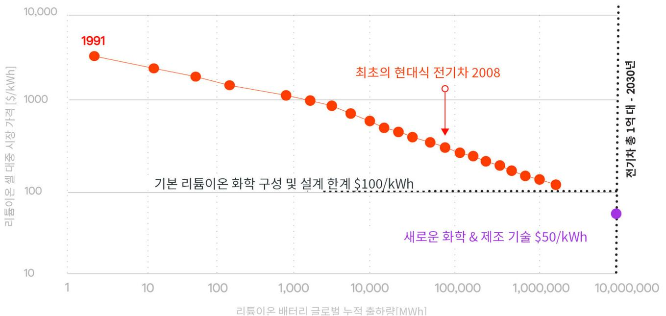
그림 3. 기존 리튬이온 배터리의 제조 학습 곡선은 그 규모가 이전에는 헤아릴 수 없었던 양에 도달했음에도 불구하고 평평해지고 있다.
