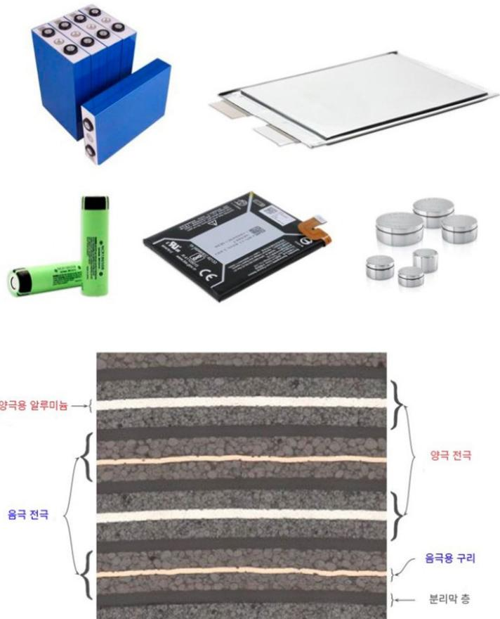
그림 6. 상단의 5 개 이미지는 리튬이온 셀의 다양한 폼 팩터를 보여준다. 프리즘형 및 파우치형은 자동차 시장용, 원통형, 파우치형, 버튼형은 전자제품 시장용이다. 리튬이온 배터리의 폼 팩터 또는 응용 분야에 관계없이, 광학 단면 이미지 (하단)는 오늘날 모든 리튬이온 셀에서 볼 수 있는 레이어 구조를 나타낸다.
