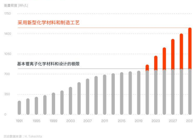
图 2. 能量密度的增加使电池能够存储更多电荷，同时大规模制造降低了电池成本。这一组合推动企业降低了每 kWh 的价格。然而，今天使用的化学技术已经达到极限，我们需要一条全新的技术曲线。
